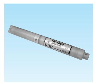
海洋、河川、湖沼、水槽、生け簀等の表層から水深1200mまでの水温計測が可能なデジタルメモリ式水温計です。小型、軽量に加え、携帯、保管、取り扱いが容易なため、他の機器への取り付けも可能です。また、連装することで水平や垂直の細かな水温分布などの計測も容易にできます。水温計の測定間隔は、1秒~24時間まで任意に設定でき、設定された測定間隔毎に、時刻と水温を自動計測し、最大2,400,000データをメモリに記憶します。
