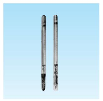
転倒採水器、転倒装置等に取り付けて任意の深さで転倒させ、 転倒した深さの水温を保持します。深海の水圧にも耐え、高い 精度を有します。
